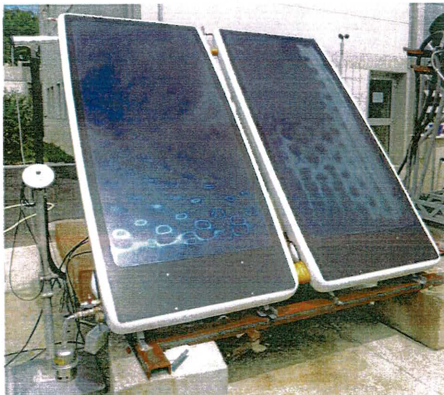
Photographie n° 2 : Chauffe eau sur le banc d'essais.
